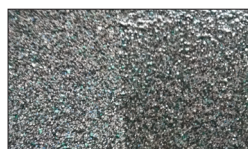
Finition avec du quartz coloré et une couche de finition transparente
