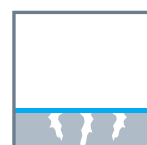
Pontage de fissures
